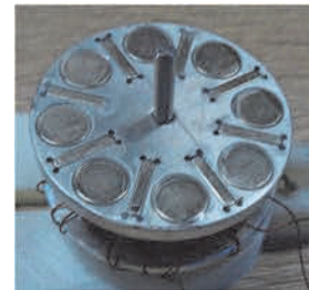
図2、アキシアルギャップ・ハルバツハ型モーター
