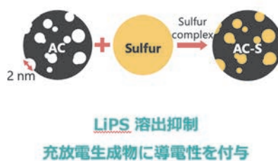
マイクロ多孔性カーボン (AC, 細孔径 &lt; 2 nm) に硫黄を複合
